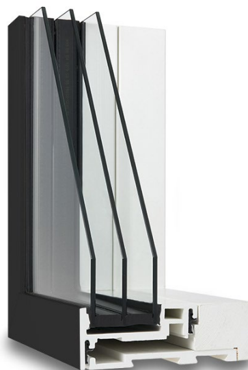
Figur 2: Kompositfönster i genomskärning. Det grå/svarta utvändiga profilen är tillverkad i kompositmaterial och den vita är den invändiga träprofilen. Källa: Ecliptica.
